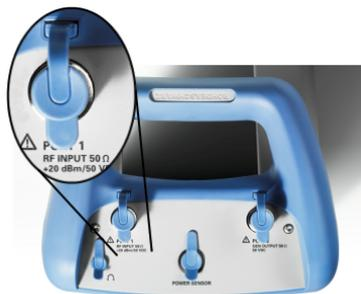
Подключите кабель или тестируемое устройство (ТУ) к ВЧ-входу с помощью N-разъема. Для подключения ТУ к R&S FSH может потребоваться кабель. Убедитесь, что R&S FSH не будет перегружен.
