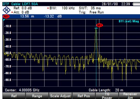
Синяя вертикальная линия отображает позицию маркера по горизонтальной оси (например, оси частот).
