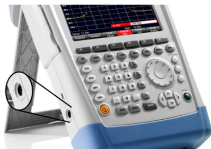
Через разъем питания постоянного тока прибор R&S FSH питается от сетевого адаптера питания (преобразователя переменного тока в постоянный). Разъем питания постоянного тока можно также использовать для зарядки аккумулятора.
