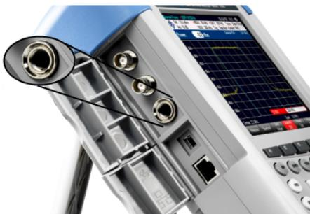
К разъему AUX можно подключать различные принадлежности, вроде GPS-приемника R&S HA-Z240 (номер для заказа 1309.6700.02).
