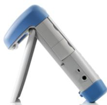
При укладке прибора горизонтально для работы с ним сверху, R&S FSH будет слегка наклонен вперед, так как ручка наверху анализатора выступает назад. Это положение дает оптимальный угол обзора экрана.
